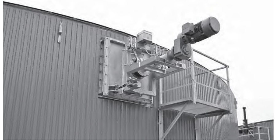
Außenständer-Wand-Konstruktion zum Einsatz in einem Stahlbehälter. Zur technischen Klärung ist vorab ein Fachgespräch notwendig.
